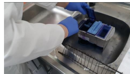
nosač uroniti u Giemsa otopinu (kontrastno bojenje) 15 min
